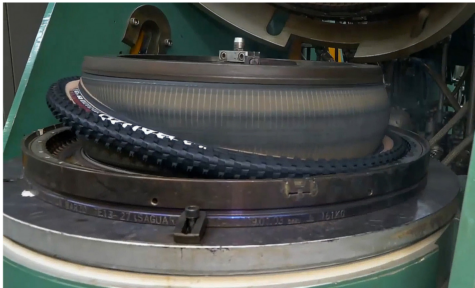
FIGURA 7. Un esempio di pneumatico nello stampo.
