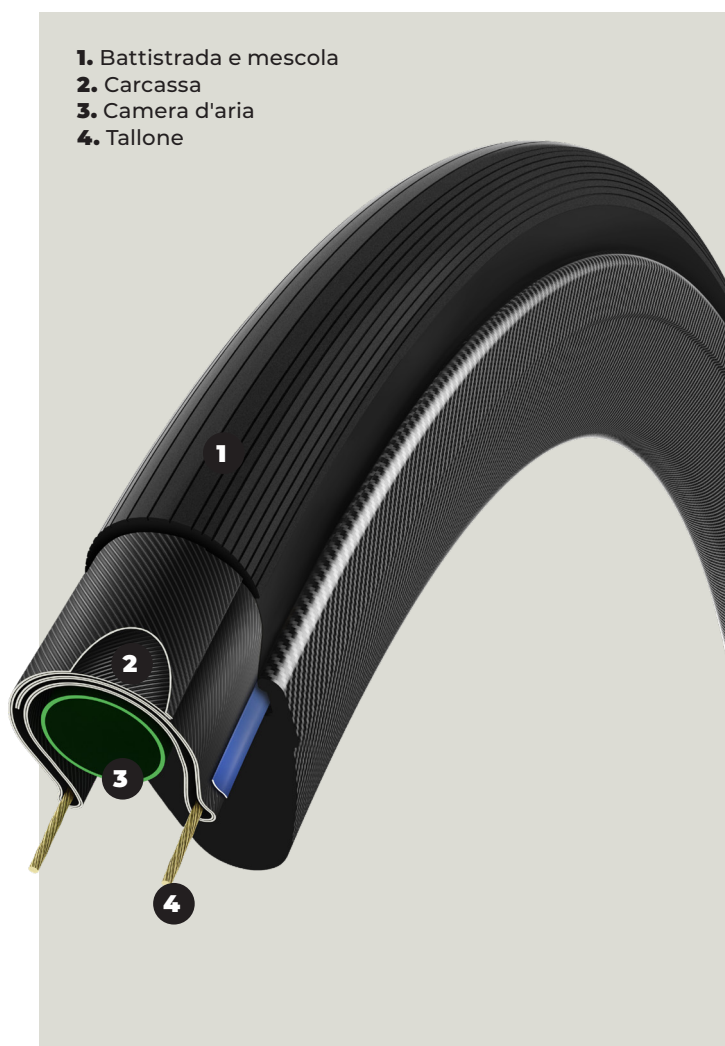
FIGURA 1. Un esempio di costruzione del copertoncino con camera d'aria.
